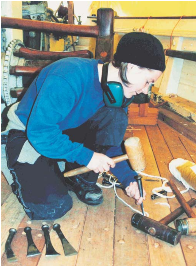
Bootsbaulehrling Laura Hellring beim Kalfatern des neuen Decks
